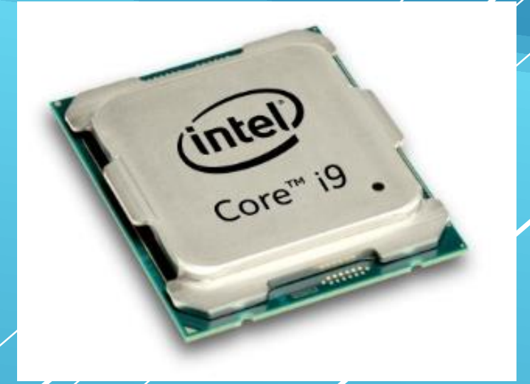
Intel Core i9 - 2017 4 milyar transistör 2.4 cm 2
